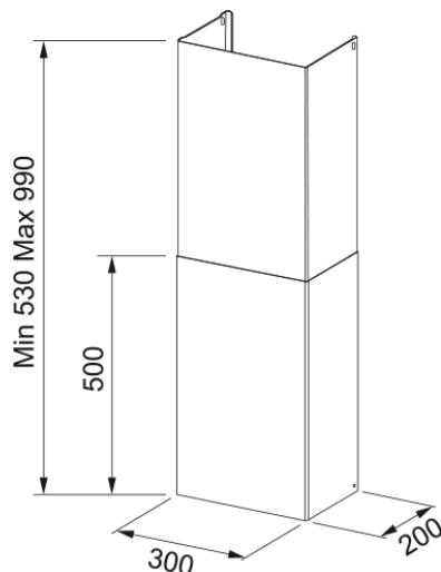
Kamin teleskop für Ab- Umluftbetrieb Kamin, Ab- und Umluftbetrieb, teleskopierbar, 500/480mm, Edelstahl, inklusive Befestigungsmaterial, 980x300x200mm, inklusive Umluftsatz
